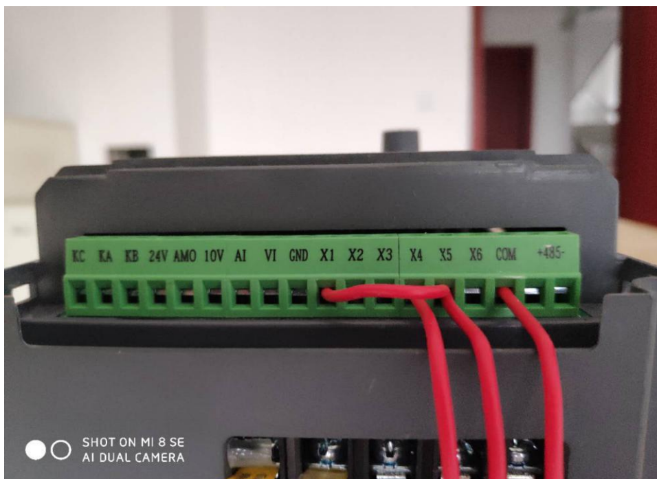
512M 在包装机械称重机接线图
